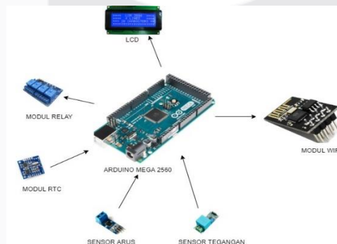
Gambar 6 Desain Perangkat Keras pada wireless smart energy meter .
