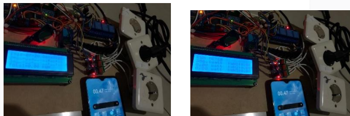
Gambar 9. Tampilan LCD yang memberikan informasi tentang daya dan waktu perangkat disambungkan
