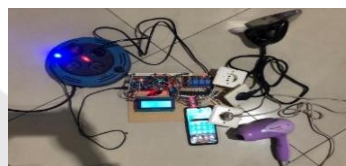
Gambar 9. Tampilan LCD yang memberikan informasi tentang daya dan waktu perangkat disambungkan
