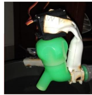
Gambar 4.2.1 Pengujian Motor Servo MG966R dengan Keran Air
