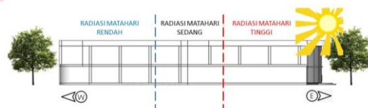
Gambar 2 Sisi Bangunan Dengan Paparan Radiasi Sinar Matahari
