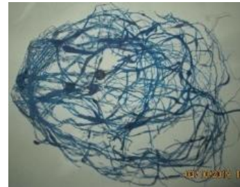
Gambar 3. Lembaran tekstil dari olahan limbah tutup botol plastik
