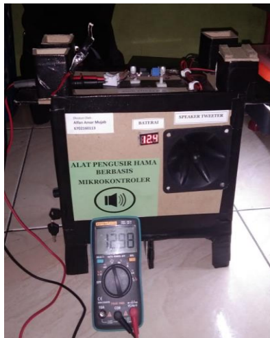
Gambar 4.6 Pengujian sensor LDR Pada Malam Hari
