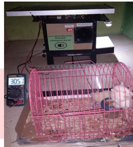
Gambar 4.12 Pengujian Frekuensi 30KHz
