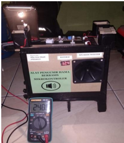
Gambar 4.5 Pengujian Sensor LDR Saat Mendeteksi Cahaya
