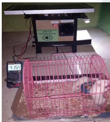
Gambar 4.11 Pengujian Frekuensi 40KHz
