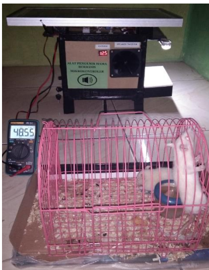
Gambar 4.10 Pengujian Frekuensi 50KHz
