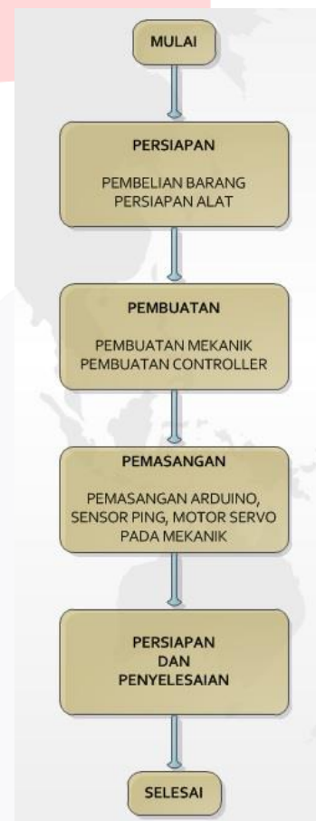
Gambar 4 2 Langkah pembangunan alat sorting menggunakan sensor warna berbasis arduino
