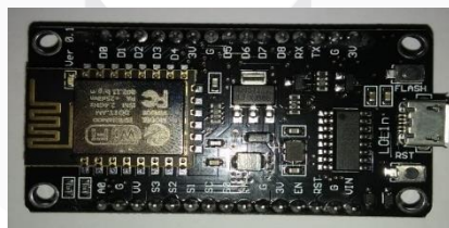
Gambar 2.5 NodeMCU ESP8266 v3 Lolin
