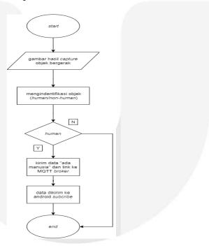
Gambar 3. 2 Diagram Alir Sistem Identifikasi pada server ke Android
