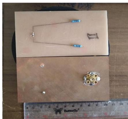
Gambar 7 Hasil cetak antena *V-Shaped* dengan pembebanan resistif
