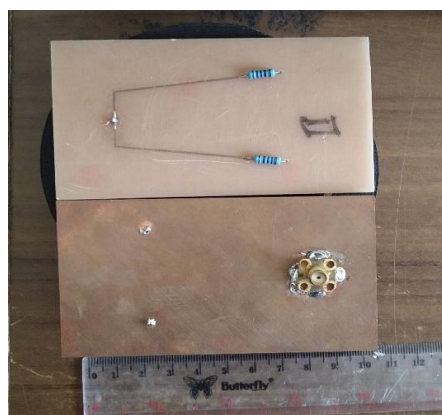
Gambar 7 Hasil cetak antena V-Shaped dengan pembebanan resistif
