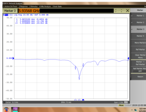
Gambar 4. 1 Grafik S11 Hasil Pengukuran Pada Vektor Network Analyser
