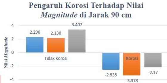
**Gambar 7** Grafik pengaruh korosi terhadap nilai *magnitude* di jarak 90 cm. Pada Gambar 7 di jarak 90 cm, pengaruh dari korosi sangat terlihat pada objek seng dan tembaga. Sedangkan pada besi korosi tidak terlalu jauh perbedaannya.
