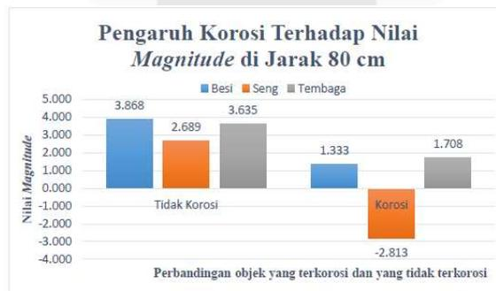
**Gambar 6** Grafik pengaruh korosi terhadap nilai *magnitude* di jarak 80 cm. Berdasarkan Gambar 6 korosi sangat berpengaruh terhadap nilai *magnitude* objek. Ini terbukti pada pengujian 3 objek menghasilkan hasil yang sama.
