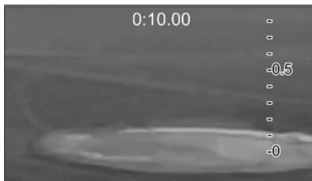
Gambar 12. Merupakan hasil dari pipet 0.4cm dengan jarak 10cm dapat menghasilkan waktu 10.00 detik, dan mendapatkan jarak pantul droplet 0.5cm
