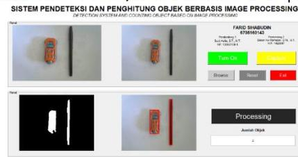
Gambar 4 16 Contoh pengujian terhadap lux 25
