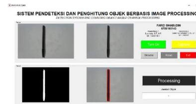
Gambar 4 19 Contoh pengujian terhadap lux 5955
