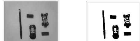
Gambar 3 6 Grayscale(kiri), Threshold(kanan)
