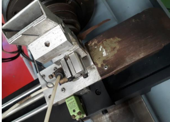
Gambar. I.3 Komponen yang terkena korosi berupa karat
