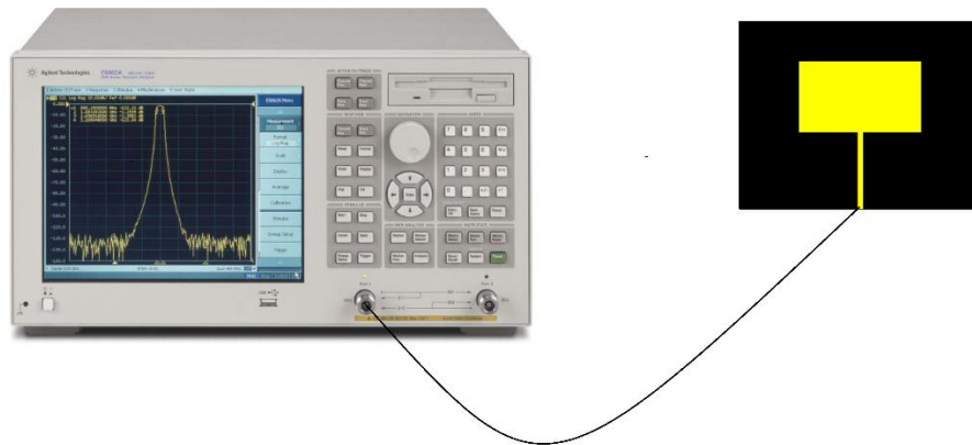
Gambar 4.2 Konfigurasi Pengukuran Medan Dekat
