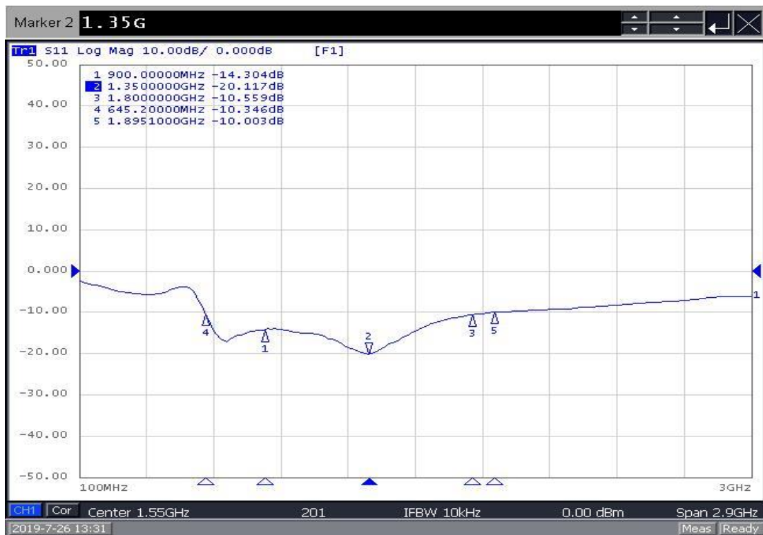
Gambar 4.3 Hasil return loss Pengukuran Antena Kondisi Biasa
