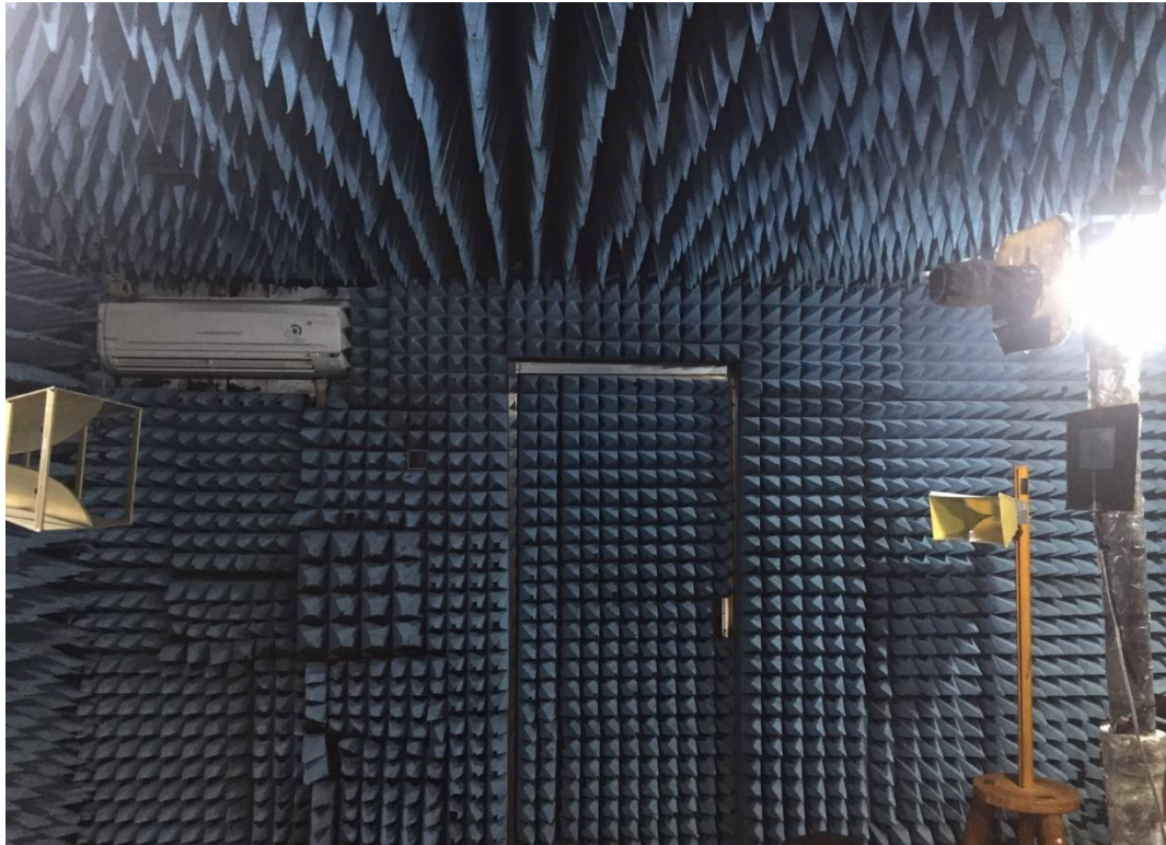
Gambar 4.14 Pengukuran medan jauh antena
