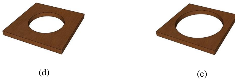
Gambar 2.3 Sampel Objek Kayu dengan Variasi Luas Lubang (a) Lubang 0 \text{ cm}^2 , (b) Lubang 0,785 \text{ cm}^2 , (c) Lubang 3,142 \text{ cm}^2 , (d) Lubang 7,069 \text{ cm}^2 , (e) Lubang 12,566 \text{ cm}^2 .
