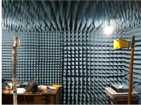
Gambar 7. Skema Pengukuran Gain dan Pola Radiasi.
