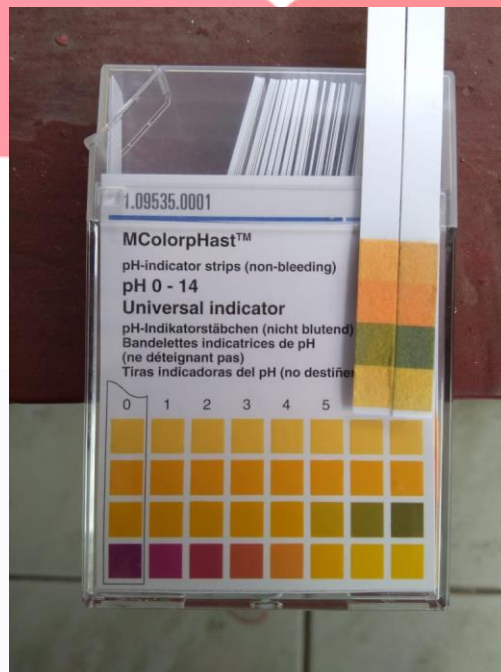
Gambar 4 Hasil Pengujian pH Air Galon
