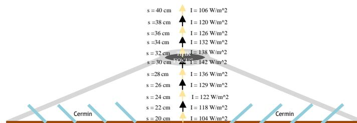
Gambar 3. Pengujian titik fokus menggunakan tabung
