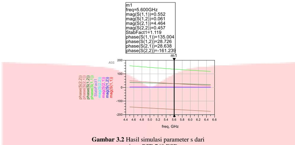
Gambar 3.2 Hasil simulasi parameter s dari transistor BFP 740 ESD.
