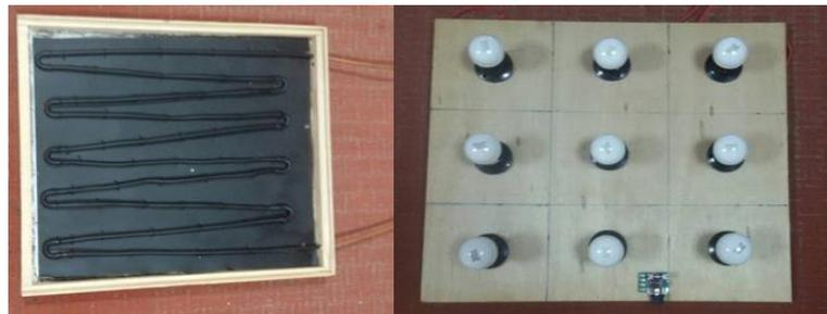
*Gambar 1 Kolektor Termal Surya dan Simulator Radiasi Matahari*
