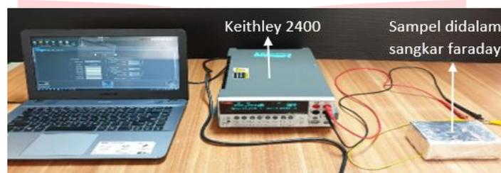
Gambar 2.1. Skema pengukuran sifat listrik lapisan  $\text{MoS}_2$  di atas substrat
