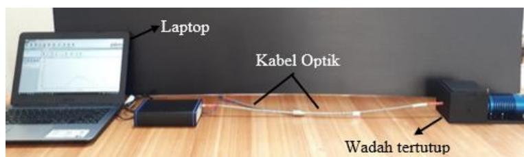
Gambar 2.1. Skema Pengukuran Transmisi Cahaya yang Melewati Sampel
