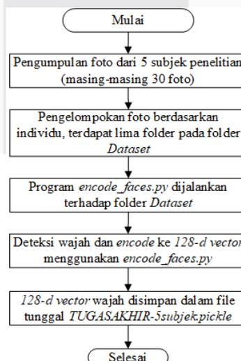
Gambar 3: Flowchart proses konstruksi 128-d vector wajah
