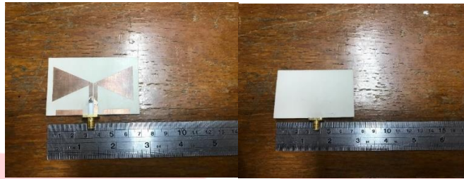
Gambar 6 Hasil Pabrikasi Antena Tampak Depan (a), Belakang (b)
