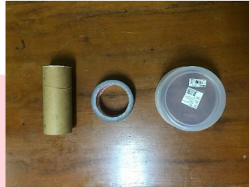
Gambar 13. Tabung Dengan Diameter 6, 9 dan 14 cm Untuk Uji Fleksibilitas
