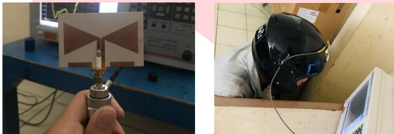
Gambar 7 Pengukuran VSWR dan Bandwidth Kondisi Biasa dan onbody
