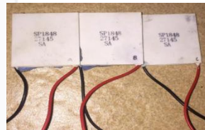
Gambar 3.3 Modul TEG (A, B, dan C) tipe SP-1848
