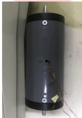
Gambar 8. Bentuk akhir generator linier tubular 3 fasa
