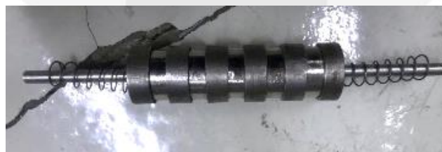
Gambar 6. Hasil fabrikasi bagian rotor
