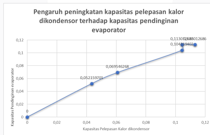
Gambar 4.1. Grafik pengaruh peningkatan kapasitas pelepasan kalor di kondensor terhadap kapasitas pendinginan
