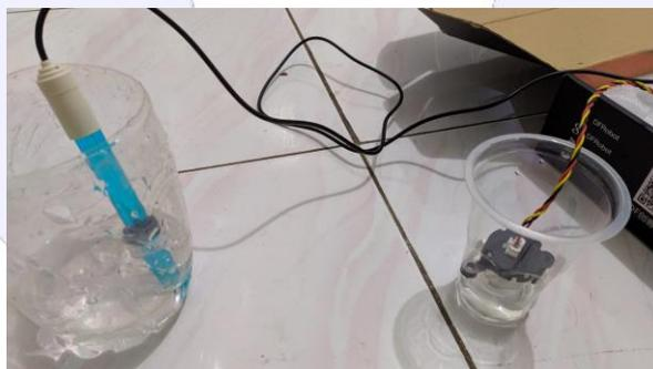
Gambar 3.1.3 Sensor pH dan Sensor turbidity
