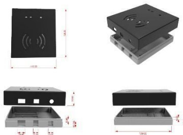
Gambar 3.3 Desain RFID Pintu Kamar Asrama
