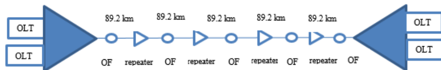
Gambar 3.2 Perancangan Sistem Komunikasi Kabel Laut (SKKL)
