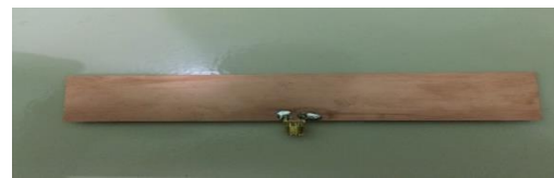
Gambar 8 Realisasi antenna tampak belakang
