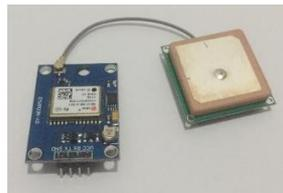
Gambar 4. Modul GPS NEO-6M
