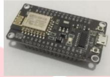
Gambar 2. Nodemcu.
