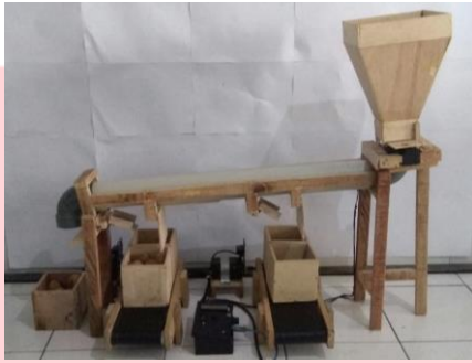
Gambar 5. Prototype Mesin Penyortiran dan Pengemasan Benih Kentang
