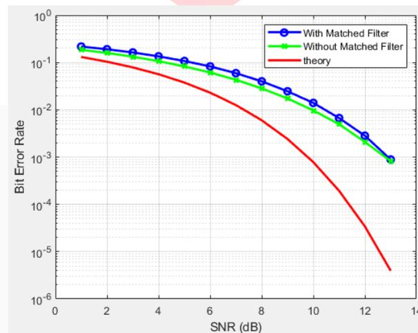
Gambar 4.6 Perbandingan BER di posisi UE terjauh pada sistem VLC menggunakan matched filter dan tanpa matched filter
