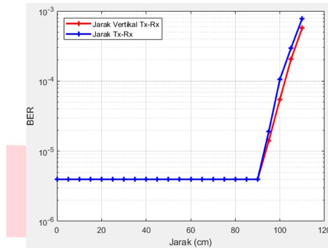
Gambar 4.1.1 Perbandingan BER Terhadap Jarak antara Source dan UE pada Sistem VLC tanpa Matched Filter
