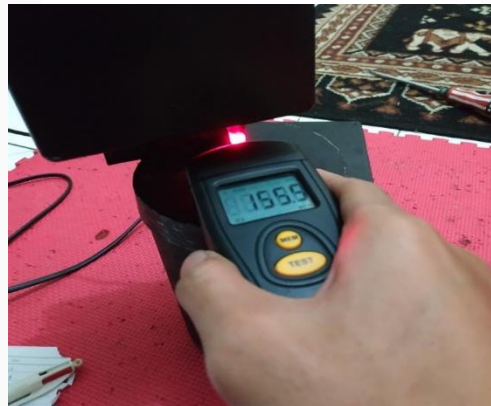
Gambar 5. 1 Pengukuran Kecepatan Menggunakan Tachometer
