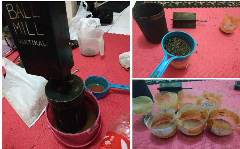
Gambar 5. 3 Penggilingan Dengan Bahan Serpihan Batu Bata, Penyaringan Bahan, dan Hasil Penggilingan
