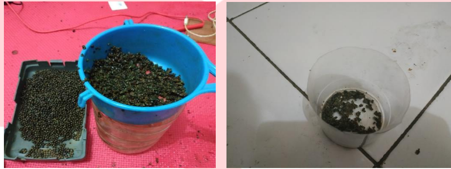
Gambar 5. 5 Penyaringan Zeolit dan Hasil Penggilingan Zeolit
