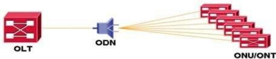
Gambar 2. 2 Konfigurasi Sistem GPON [7]
