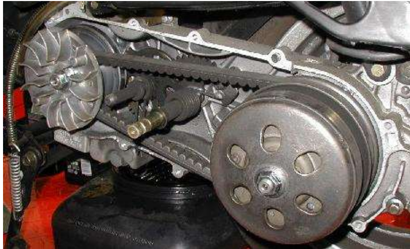
Gambar I.2 Pulley Assy dan Belt Drive yang sudah dirakit pada crankcase
