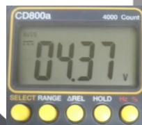
Gambar-12 Tegangan output regulator tanpa beban
