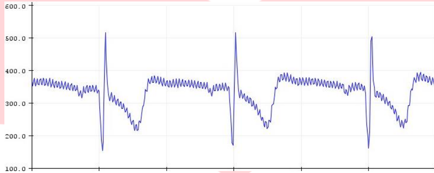
Gambar IV- 1 Pengujian 1 AD8232 Subjek 1
