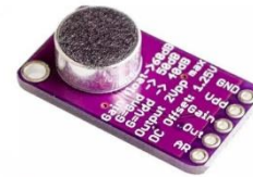
Gambar 4 Sensor Suara Max9814
