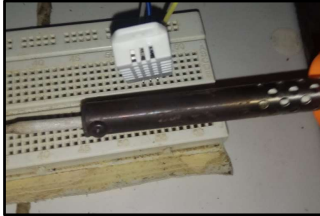
Gambar 4. 9 Pengujian batas maksimum sensor DHT22
