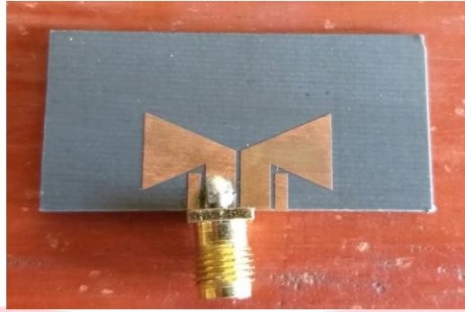
Gambar 8 Realisasi Antena Microstrip Bowtie
