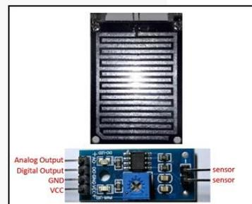
Gambar 2. 5 Flying Fish & Piringan Sensor Air
