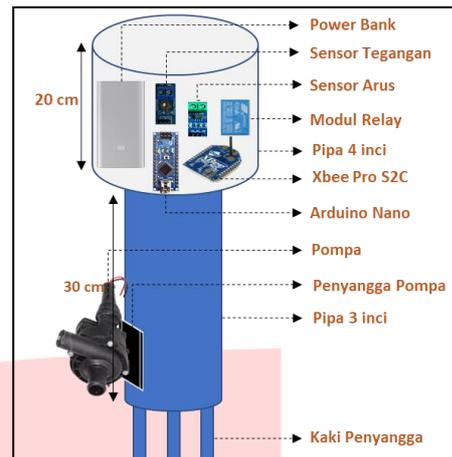
Gambar 3. 7 Desain Alat Titik Buang
