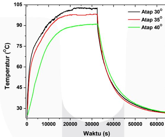
**Gambar 3.5.** Grafik temperatur udara terhadap waktu pada atap kemiringan 30° dan 35°
