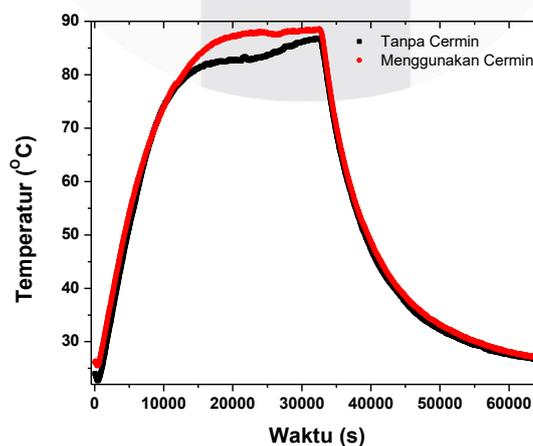
**Gambar 3.1.** Grafik temperatur air terhadap waktu pada basin menggunakan cermin dan tidak
