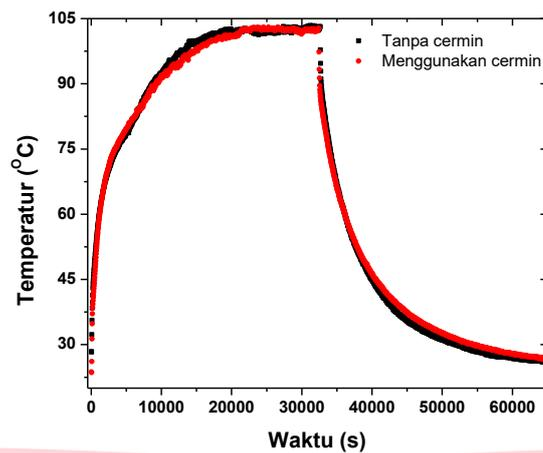
**Gambar 3.2.** Grafik temperatur udara terhadap waktu pada basin menggunakan cermin dan tidak
