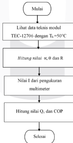
Gambar 3. 3 diagram alur pengujian perhitungan Q_c dan COP TEC-12706 berdasarkan data teknis
