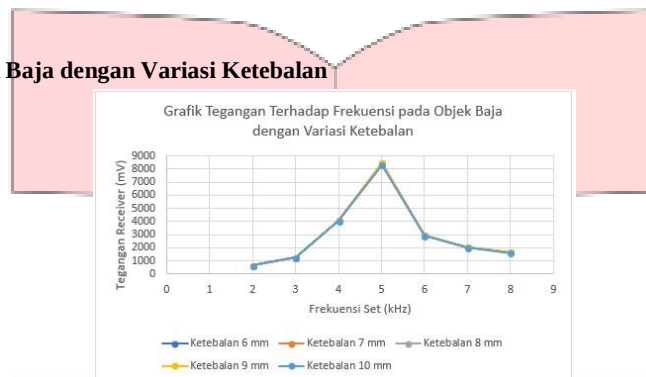
Gambar 11. Grafik Tegangan Induksi Koil Penerima Terhadap Frekuensi pada Objek Baja dengan Variasi Ketebalan
