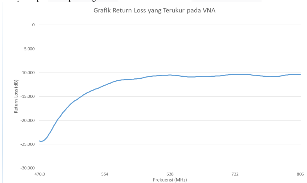
Gambar 3.3 Return Loss pada VNA
