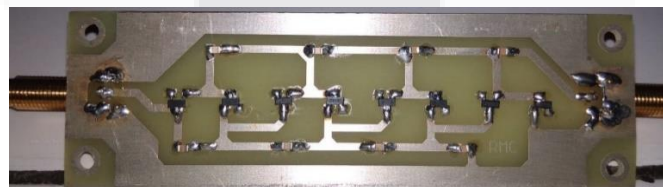
Gambar 3.4 Hasil Realisasi Rectifier
