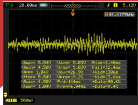
Gambar 10 Sinyal audio setelah dikuatkan
