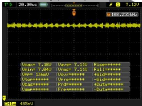
Gambar 7 Sinyal video keluaran photodiode
