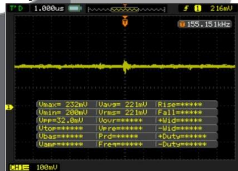
Gambar 8 Sinyal audio keluaran photodiode
