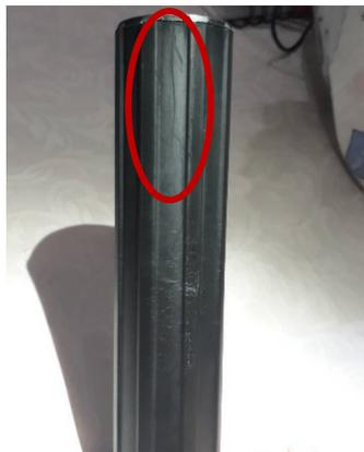
Gambar I. 4 Jenis *defect* belang pada grip panjang
