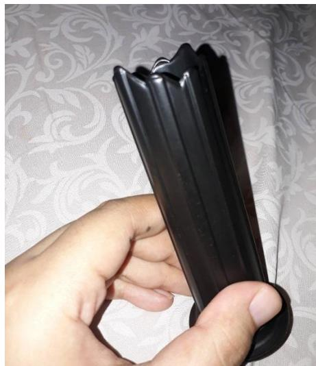
Gambar I. 4 *Short Mold* pada Grip Panjang
